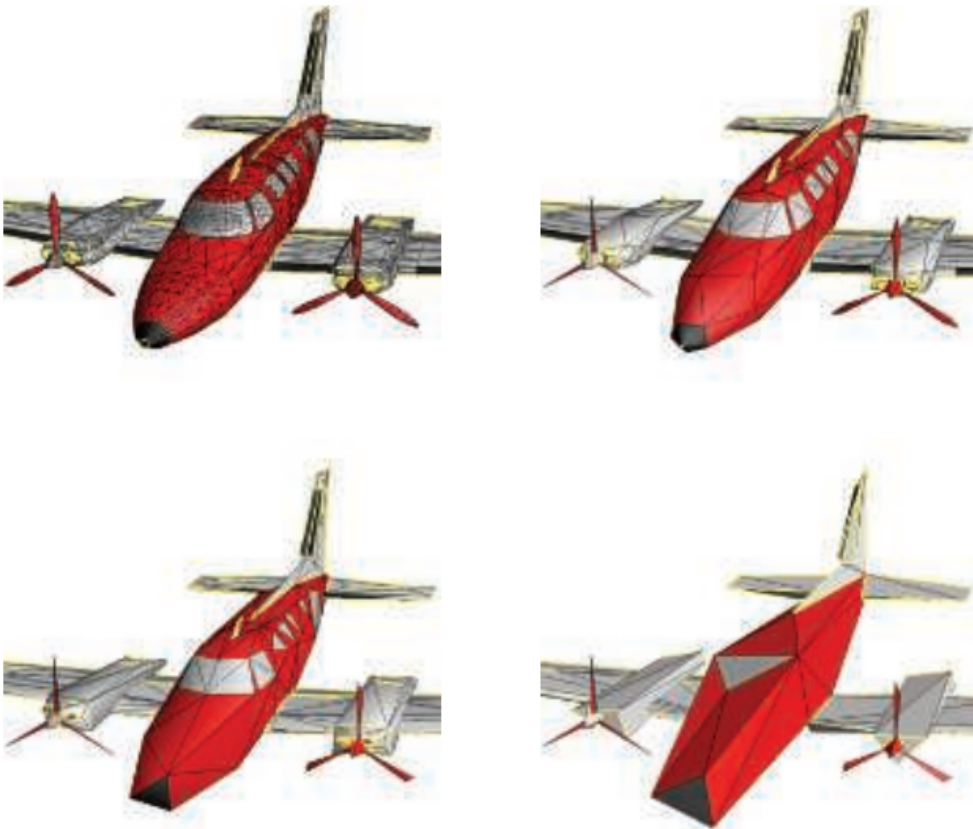
图 16.20：网格简化。左上角是包含 13546 个面的原始网格，右上角被简化为 1000 个面，左下角为 500 个面，右下角为 150 个面[770]。
